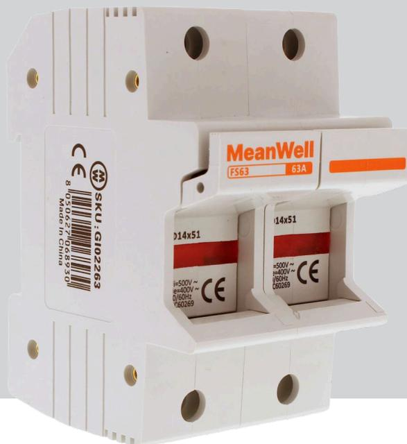
I portafusibili della serie FS63 sono dispositivi di protezione progettati per garantire la sicurezza dei circuiti in condizioni di sovracorrente. Realizzati con un design modulare e compatti, si installano facilmente su guida DIN da 35 mm. Compatibili con fusibili da  $\Phi 14 \times 51$ , offrono protezione efficace fino a una tensione nominale di 500 V e una corrente nominale di 63 A, rendendoli ideali per applicazioni commerciali e industriali.
