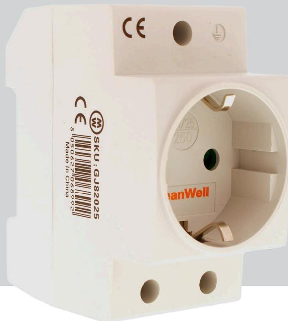
Queste prese Schuko Modulare Tipo F sono progettate per fornire un'interfaccia di alimentazione affidabile e conveniente per apparecchiature elettriche. Con una corrente nominale fino a 25A e un grado di protezione IP20, sono adatte per applicazioni in ambienti con temperature da -25°C a +55°C. La loro robusta costruzione supporta fino a 5000 cicli di inserimento della spina, offrendo durabilità e sicurezza per l'uso quotidiano.
